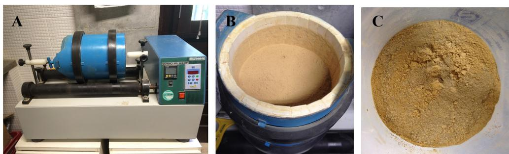
Prevendo-se que a tonalidade final poderia variar entre 40 e 50% de sua intensidade cromática inicialmente produzida (SISI et. al., 1998), as quantidades de pigmento foram testadas previamente à sua aplicação. Foram realizados testes com 5, 10, 20 e 50 cm<sup>3</sup> do pigmento (Figura 29) já disperso misturando estas quantidades em 1 litro de caiação. Os pigmentos foram embebidos em água quente para assegurar completa dispersão e misturados com batedor manual.
