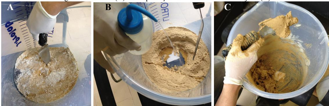
A quantidade de água adicionada foi a necessária para permitir sua trabalhabilidade e não afetar negativamente a porosidade, a compactação, a permeabilidade e a resistência mecânica, evitando o aumento da retração deste material.
